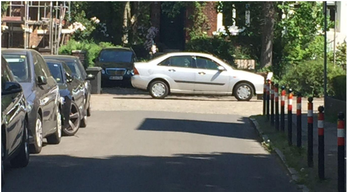
Albrecht-Dürer-Straße: Poller verhindern aufgesetztes Parken.
